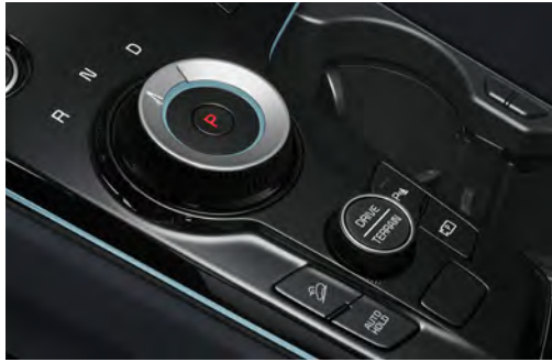
ناقل الحركة الإلكتروني Shift By Wire Transmission Control (SBW)
